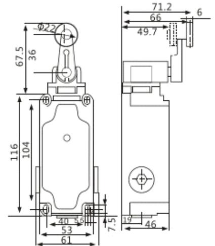
привод рычаг с роликом
